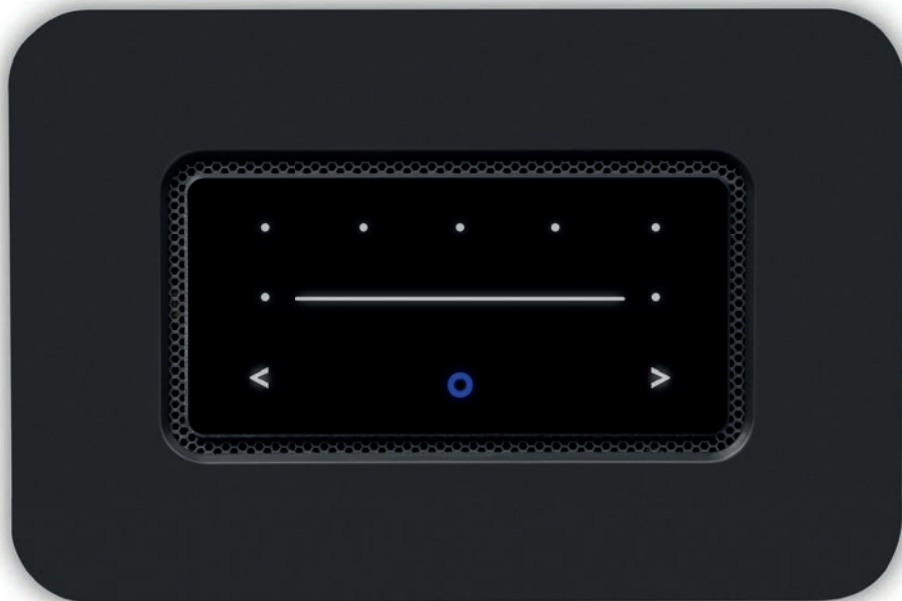
Tlačítka na přístroji nahradily dotykové senzory na horním panelu. Jejich pomocí lze snadno ovládat přehrávání, volit pauzu, hlasitost a také uložené předvolby.
